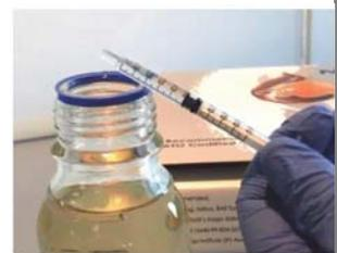
A.1.6 Insérez le bout de l'aiguille dans le goulot du flacon de test MicrobMonitor2 et injectez l'échantillon en poussant complètement le piston de la seringue.
