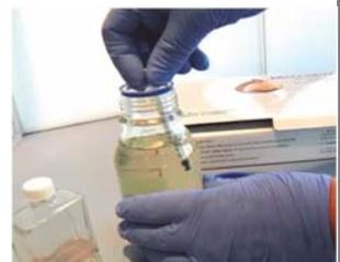
A.1.5 Aspirez du carburant jusqu'à plus de la moitié de la seringue. Ensuite, avec l'embout de la seringue vers le haut, pousser le piston pour expulser l'air. Expulser le surplus de carburant jusqu'à ce que l'extrémité du piston atteigne la marque correspondant au volume requis. (Cf. tableau 1.)
