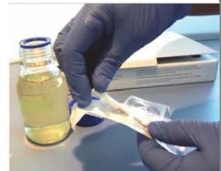
A.1.4 À l'aide de la seringue, aspirez du carburant à environ 3 cm sous la surface de l'échantillon. Si la phase du carburant fait moins de 6 cm de profondeur, aspirez l'échantillon à mi-profondeur environ. Veillez à ce qu'il n'y ait pas de transfert de particules interfaciales visibles, de gouttes d'eau ou d'émulsion dans l'échantillon à tester.
