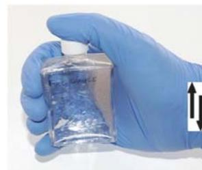
**B.3** Arrêtez brusquement d'agiter le flacon de test, de sorte que le gel se dépose au fond. Passer immédiatement à l'étape B4.
