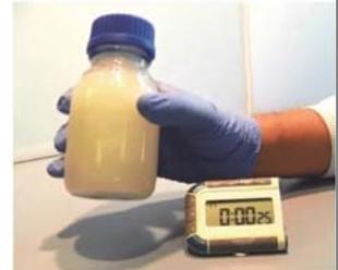
A.1.2 Retirez le capuchon du flacon de test MicrobMonitor2 en évitant d'en toucher l'intérieur et placez-le sur une surface propre.
