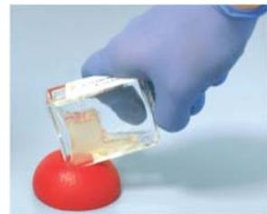
**B.2** Agiter le flacon pendant environ 30 secondes pour liquéfier le gel et disperser l'échantillon. En plus d'agiter le flacon de test, vous pouvez le taper à plusieurs reprises pendant 30 secondes sur un « Bumper » MicrobMonitor. Après agitation, le gel devrait être légèrement visqueux mais sans grumeaux et avoir une consistance uniforme et claire. La présence de bulles dans le gel est normale, elle n'influera pas sur le test.
